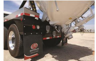
*deslizar el tanque de escombros, distribuyendo el peso desde el eje trasero al eje frontal. Las aplicaciones incluyen aspirar y acarrear residuos y productos químicos peligrosos, eliminación de agua grasienta sanitaria y grasas, así como el acarreo y transporte de lodos para apoyar la instalación de gas natural, electricidad subterránea y fibra óptica.*
