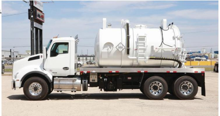
*El camión de vacío industrial Talos no tiene igual en el mercado. El exclusivo sistema "Load Boost" incluye un tanque de residuos deslizante que permite a los operadores llevar legalmente más del 30% de capacidad de carga que sus competidores. Este simple diseño utiliza el mismo cilindro para tirar y*
